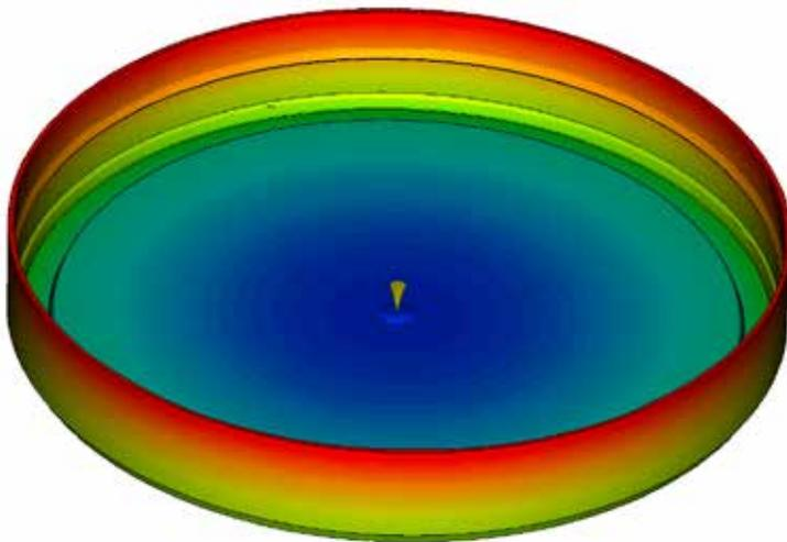
Durch die dünneren Wandstärken haben sich die mechanischen Eigenschaften des Deckels verändert, so dass der Verdeckelungsprozess innerhalb der Abfüllanlage nicht mehr einwandfrei funktionierte. Über umfangreiche Materialtests konnte eine spezielle Materialmischung ermittelt werden, die im Zusammenspiel mit der materialsparenden Geometrie die gewünschten mechanischen Eigenschaften des Deckels sicherstellte.
